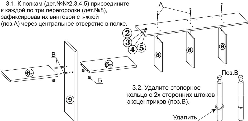
3.2. Удалите стопорное кольцо с 2х сторонних штоков эксцентриков (поз.В).
