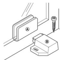
Магнитный толкатель PUSH (B) и ответная планка (A) уста навливаются по разметке. !Ответная планка уста навливается через каучуковую прокладку.
