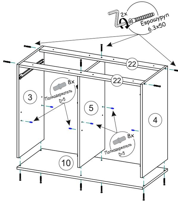
Рис.7 Схема сборки ящика
