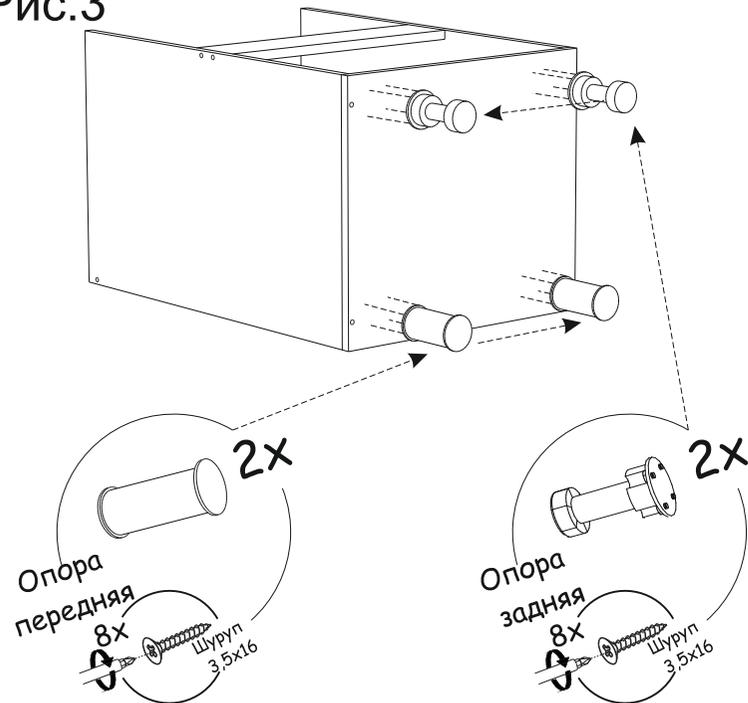
Примечание: При установке кухонного гарнитура в комплектации с цоколем спереди использовать черные опоры
