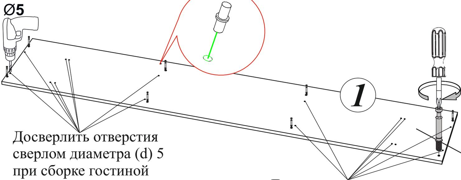
Досверлить отверстия сверлом диаметра (d) 5 при сборке гостиной на ЛЕВУЮ сторону.
