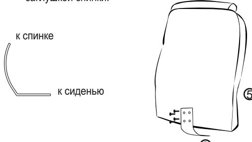
3. Наживите крестовой отвёрткой Ph3 кронштейн спинки ⑧ к сиденью ⑥ четырьмя винтами M6x25мм через отверстия в металлической площадке. Затяните все винты крепления кронштейна спинки и металлической площадки ④ .
