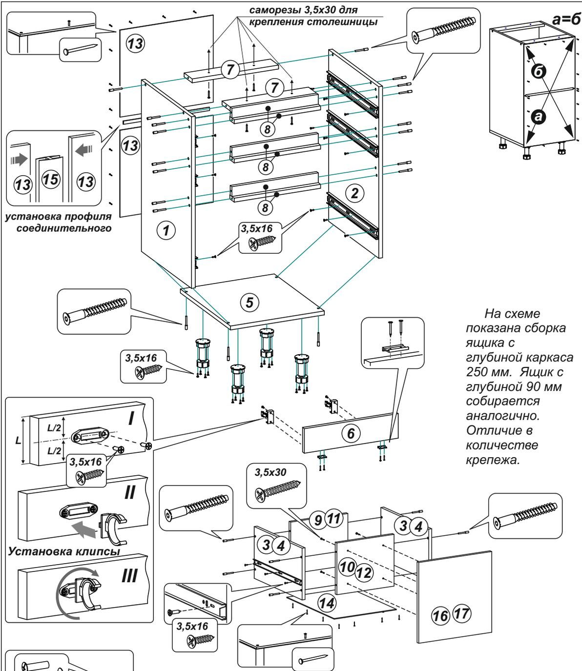
На схеме показана сборка ящика с глубиной каркаса 250 мм. Ящик с глубиной 90 мм собирается аналогично. Отличие в количестве крепежа.
