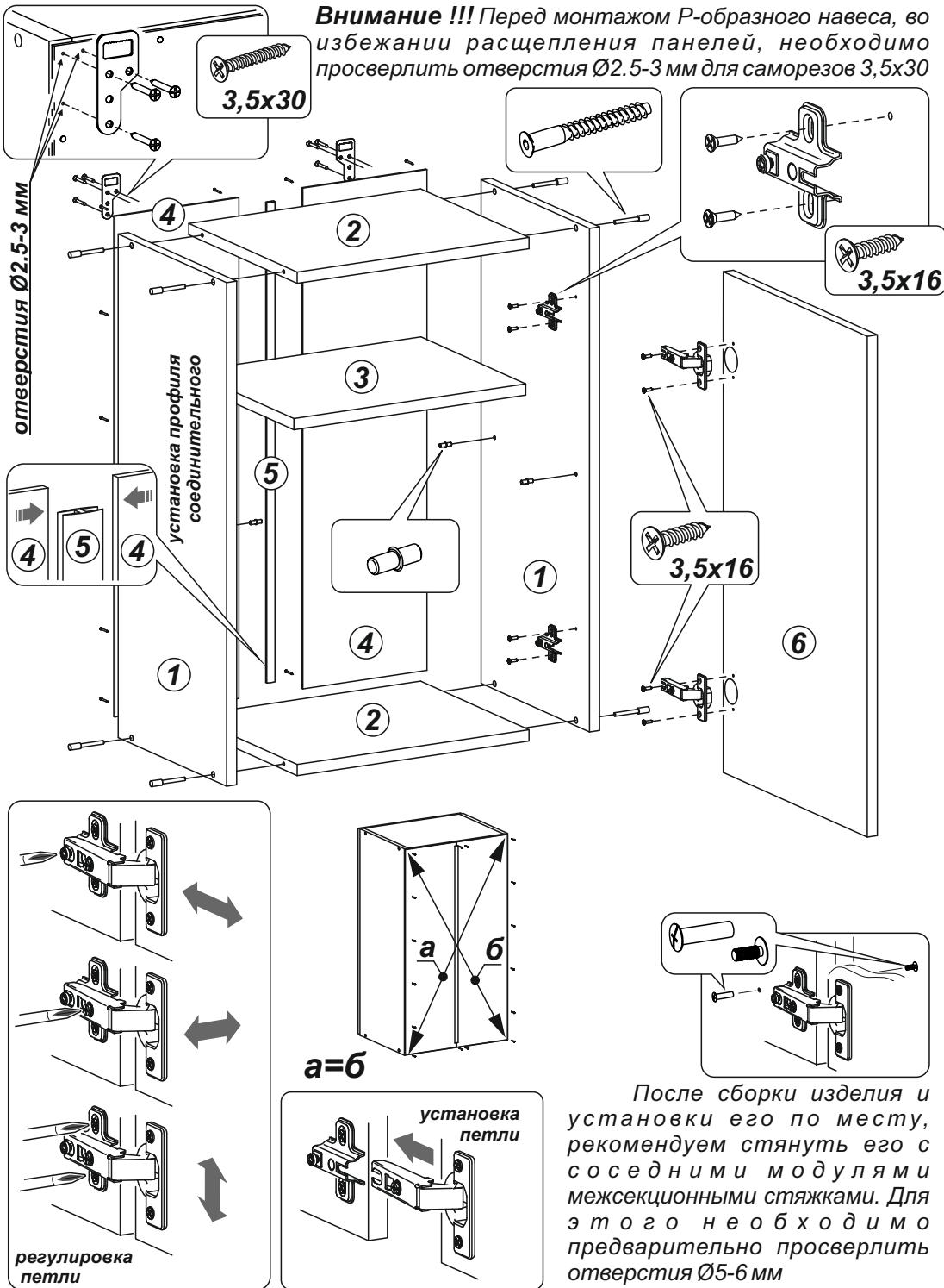
**Внимание !!!** Перед монтажом Р-образного навеса, во избежании расщепления панелей, необходимо просверлить отверстия Ø2.5-3 мм для саморезов 3,5x30
