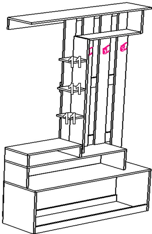
Собранные конструкции щита и тумбы соединить между собой, и скрутить еврошурупами.
