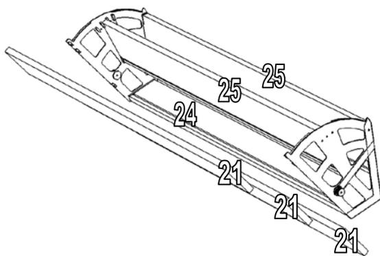
Собранный ящик установить в корпус секции. Установить ручку на фасаде 20. Закрепить ящик для обуви к боковинам 1.
