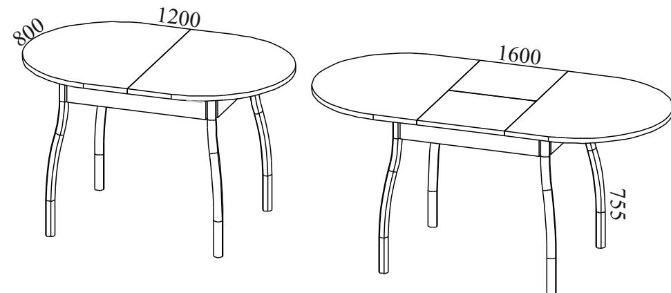
Габаритные размеры: ширина - 1200(1600) мм, высота - 755 мм, глубина - 800 мм.
