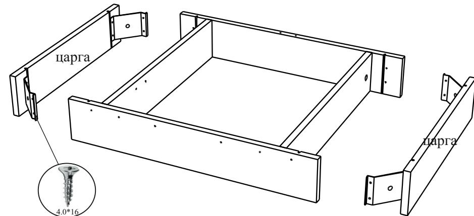
Механизм д/стола крепится к царгам (лев/пр) саморезами 4.0\*16 с пресс-шайбой, механизм “бабочка” - к перегородкам саморезами 4.0\*16. Пандус крепится к торцу царги левой саморезами 4.0\*30.
