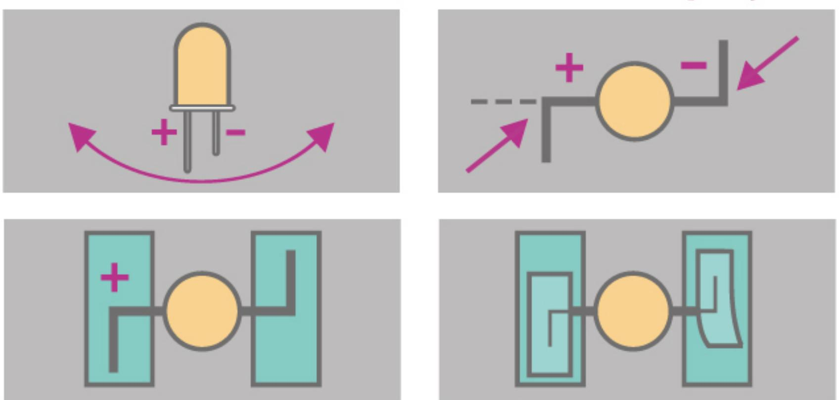
**Шаг 4.** Установите батарейку, следя изображению. Для фиксации светодиодов и питающего элемента используйте небольшие кусочки медной ленты.
