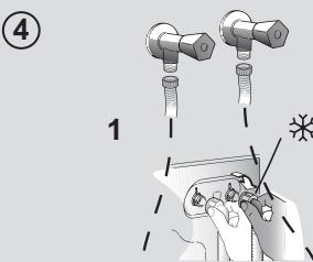
● **АКВАПРОТЕКТ** («Система захисту від протікання») – **ВОДОНАЛИВНИЙ ШЛАНГ З ДОДАТКОВИМ ЗАХИСТОМ** (**Рис.6**): Якщо вода протече з головного внутрішнього шлангу «A», то вона потрапить до прозорої захисної зовнішньої оболонки «B», що дозволить закінчити цикл прання. Після завершення циклу прання зверніться до Центру з Обслуговування Клієнтів, щоб замінити водоналивний шланг.
