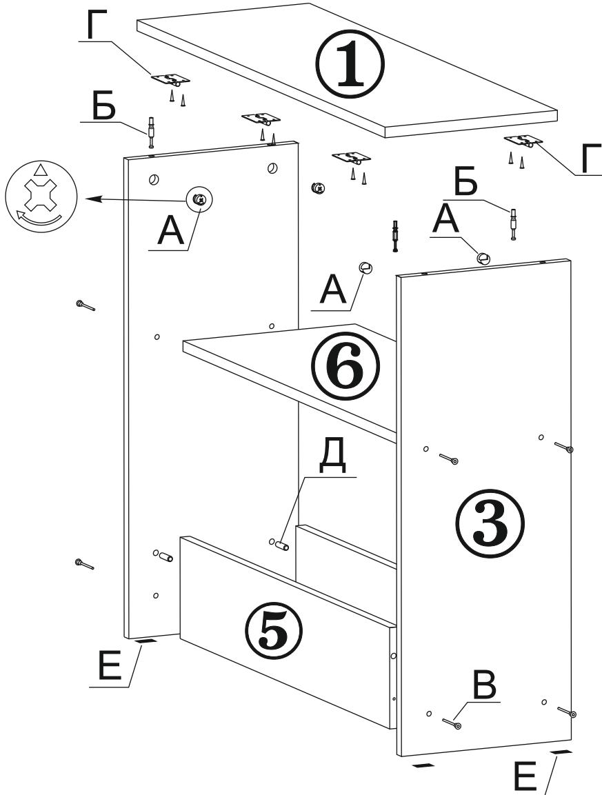
1.1. В отверстия на столешнице (дет.№1) закрутите штоки эксцентриков (поз.Б), шурупами 3,5x16 закрепите карточные петли (поз.Г).
