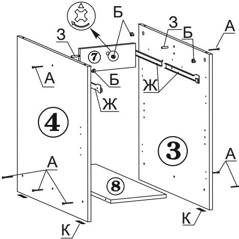
1.1. На нижних торцах боковин стола (дет.3,4) закрепите наконечники (поз.К) с помощью гвоздей. Шурупами 3,5x16 закрепите на боковинах стола (дет.№3,4) роликовые направляющие (поз.Ж).
