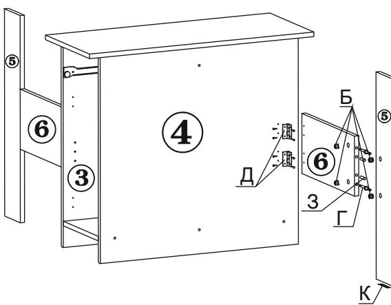
1.3. На нижних торцах выдвижных боковин стола (дет.5) закрепите наконечники (поз.К) с помощью гвоздей. В отверстия в боковинах и монтажных планок (дет.№№5,6) вставьте эксцентрики (поз.Б). Обратите внимание: стрелка на эксцентрике должна быть направлена к торцу детали.
