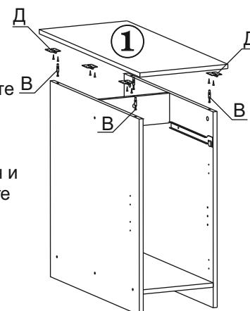
Вставьте шканты в торцевые отверстия на монтажных планках. Присоедините выдвижную опору стола к монтажной планке. Поверните эксцентрики в выдвижных опорах на 180 град. по часовой стрелке. Прикрепите шурупами 4x16 карточные петли к монтажным планкам (дет.№№6) Прикрутите карточные петли, закрепленные на монтажных планках выдвижных боковин стола (дет.№№3,4).
