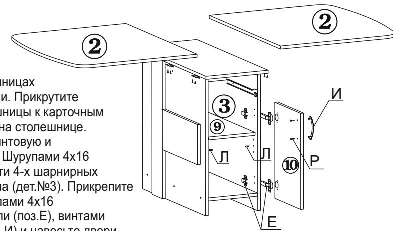
1.4. В отверстия на дополнительных столешницах вставьте полкодержатели. Прикрутите дополнительные столешницы к карточным петлям, закрепленным на столешнице. Закройте заглушками винтовую и эксцентриковую стяжки. Шурупами 4x16 закрепите ответные части 4-х шарнирных петель на боковине стола (дет.№3). Прикрепите к двери (дет.№10) шурупами 4x16 четырехшарнирные петли (поз.Е), винтами M4x20 (поз.Р) ручку (поз.И) и навесьте двери, закрепив петли на ответные части крепежными винтами.
