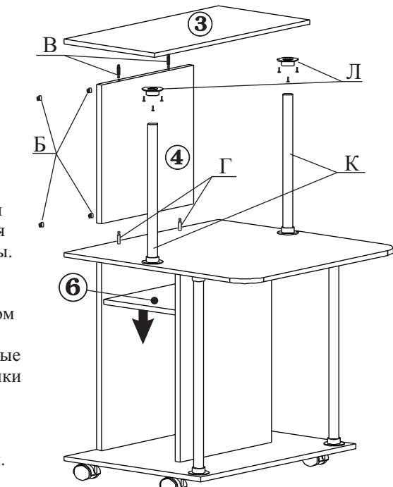
1.4. С нижней стороны полки (дет.№3), вкрутите два штока эксцентрика (поз.В) и установите два фланца (поз.Л). В заднюю стенку (дет№4), с тыльной стороны установите четыре эксцентрика (поз.Б). Установите две трубы (поз.К).
