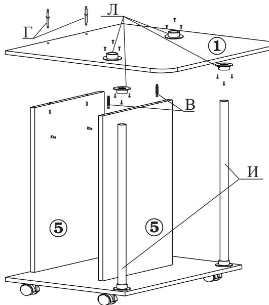
1.3. С нижней стороны столешницы (дет№1) прикрутите два фланца (поз.Л), И два штока эксцентрика (поз.В). Сверху в отверстия в столешнице (дет.№1) вставьте штоки двойных эксцентриков (поз.Г).
