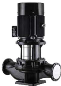
Одноступенчатый центробежный насос с сухим ротором и патрубками в линию (IN-Line), предназначенный для установки на трубах (до 4кВт) или на фундаменте (5,5кВт и более). Блочная конструкция с жесткой муфтой, с низким уровнем шума и вибрации, с фонарем и неподвижно присоединенным электродвигателем с фланцевым креплением.
