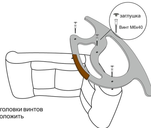
2. Взять правую боковину, у которой углубления под головки винтов на 3 отверстиях должны быть с внешней стороны и положить соответствующим образом на бок мягкой части
