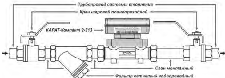
Рисунок 13 – Пример монтажа теплосчетчика в трубопровод
