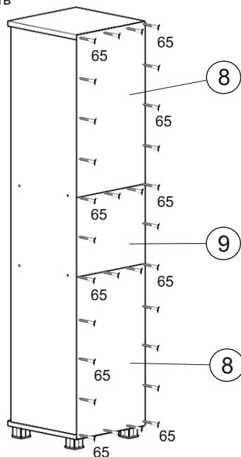
В местах соединения ДВП использовать скрепки для задней стенки 97.
