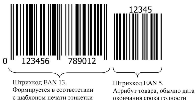
Рис. 7.2 – Структура штрихкода EAN 13+5
