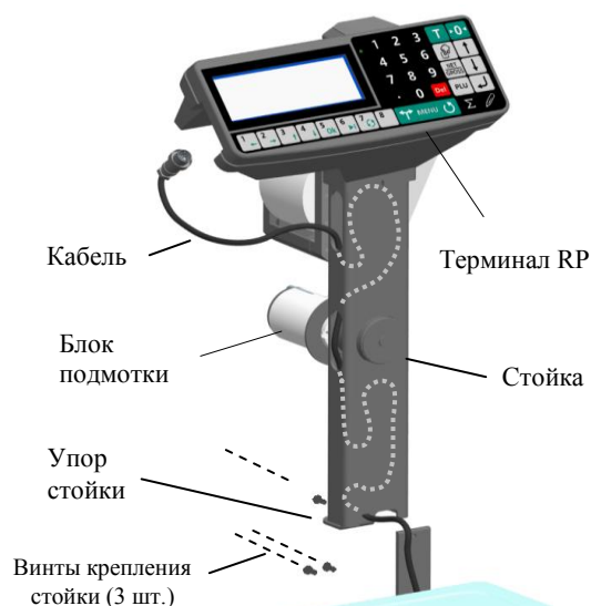
Рис. 3.3 - Сборка весов МК_RP10-1, МК_R2P10-1
