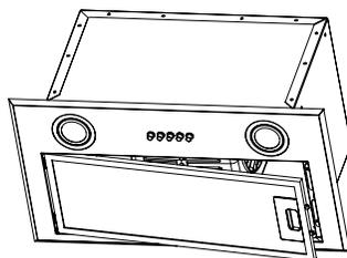
Снимите нижнюю панель, открутив 4 винта M4\*10.
