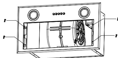
Откройте крышку коннекторной коробки, отвинтив винт ST4\*10. Разъедините коннекторы проводов панели управления и освещения.
