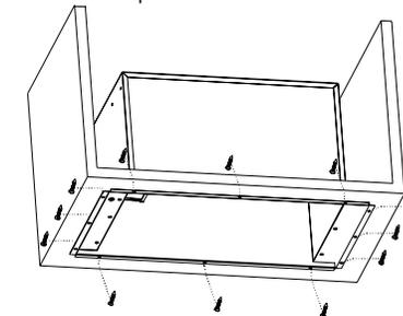
Прикрепите панель вытяжки обратно на место при помощи 4 винтов M4\*10.
