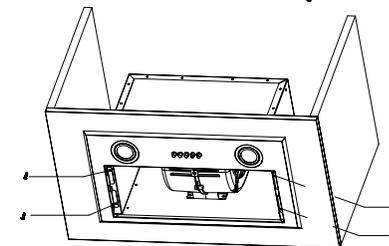
Соедините коннекторы проводов панели управления и освещения и закройте крышку коннекторной коробки.
