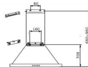
Схема установки для моделей AVEX RYS 6040 Y / B
