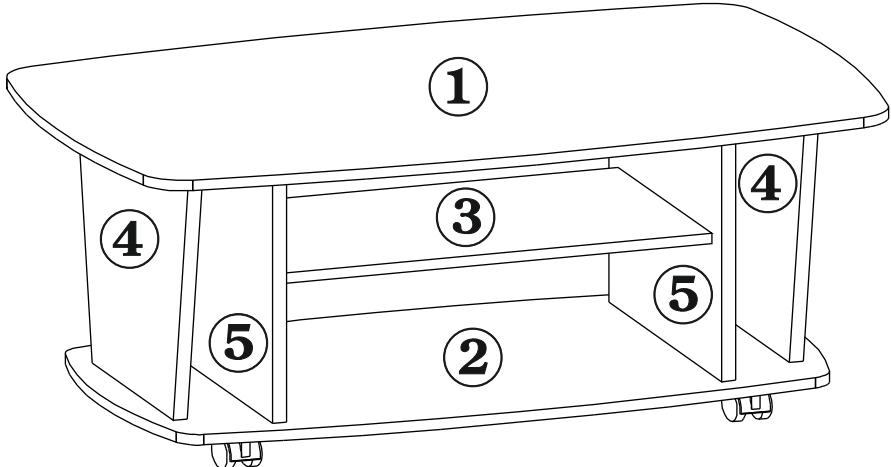
3.1. Соедините боковины (дет№5) и полку (дёт№3) с помощью винтовой стяжки (поз.А) и шкантов (поз.Г). Вставьте В отверстия в боковинах (дет№ 4 и 5) эксцентрики (поз.В).
