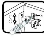
Если необходимо отрегулировать створку по высоте, нужно ослабить винт 3, отрегулировать створку в направлении С-С, а затем затянуть винт 3.
