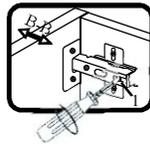
Если нижняя или верхняя часть створки отстает от корпуса, нужно ослабить винт 1 и сдвинуть створку в направлении В-В, а затем затянуть винт 1.
