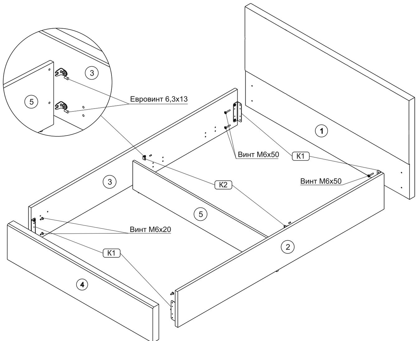
Схема 3. Установка элементов подъемного основания ортопедического
