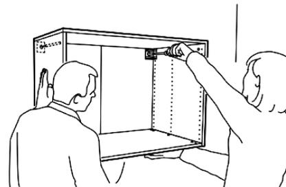
Схема установки монтажного уголка
