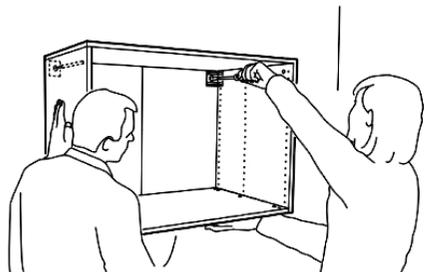
Схема установки монтажного уголка
