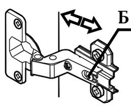
2. Регулирование глубины: Ослабить крепежный винт "Б" и отрегулировать расстояние между дверью и кромкой боковины. После этого снова затянуть крепежный винт "Б".
