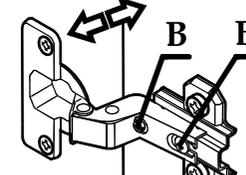
3. Регулирование наложения: Ослабить крепежный винт "Б". Установочный винт "В" повернуть по или против часовой стрелки, наложение двери увеличится или уменьшится соответственно. Затянуть винт "Б".
