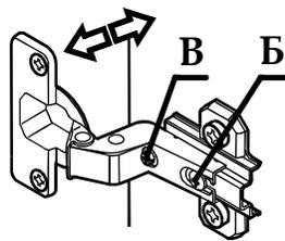
3. Регулирование наложения: Ослабить крепежный винт "Б". Установочный винт "В" повернуть по или против часовой стрелки, наложение двери увеличится или уменьшится соответственно. Затянуть винт "Б".
