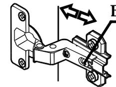
2. Регулирование глубины: Ослабить крепежный винт "Б" и отрегулировать расстояние между дверью и кромкой боковины. После этого снова затянуть крепежный винт "Б."
