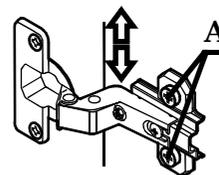
1. Регулирование высоты: Средством регулирования по высоте ответной планки винтами "А" двери могут точно выравниваться по высоте.
