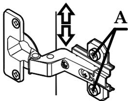
1. Регулирование высоты: Посредством регулирования по высоте ответной планки винтами "А" двери могут точно выравниваться по высоте.
