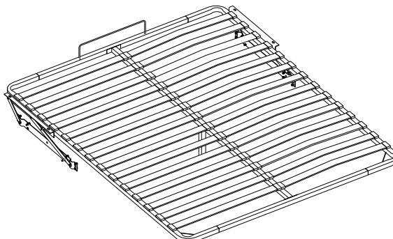
•На дет. №2, 3, 4 установить кронштейн при помощи винтов M6x20 (см. схему 3).
