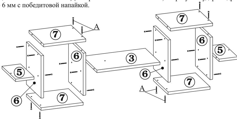
Все детали соединяются между собой с помощью Винтовой стяжки (поз.А).
