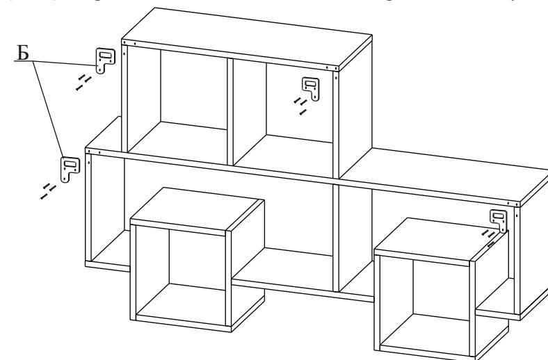
3.5. Разметте и просверлите в стене отверстия диаметром 6 мм. Забейте пластиковые дюбели и закрутите в них шурупы 4x40. Повесьте полку.
