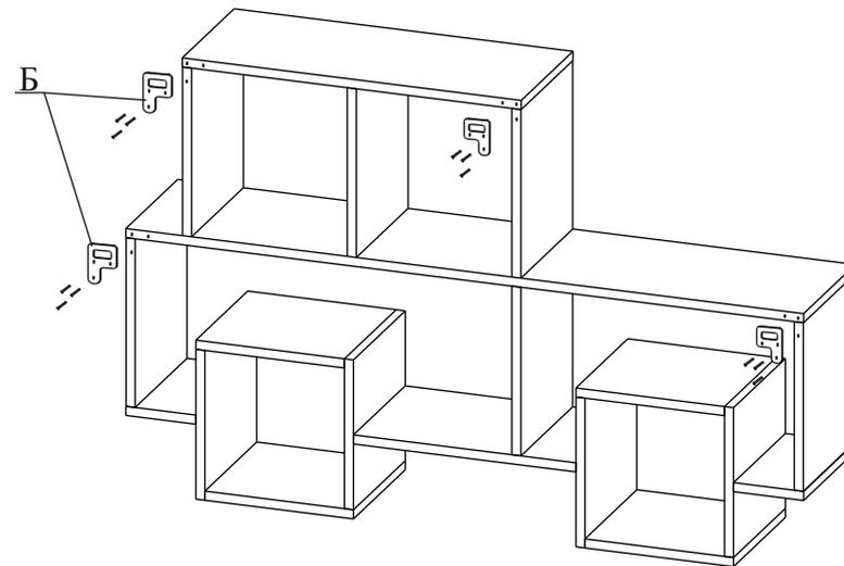
3.5. Разметьте и просверлите в стене отверстия диаметром 6 мм. Забейте пластиковые дюбели и закрутите в них шурупы 4x40. Повесьте полку.
