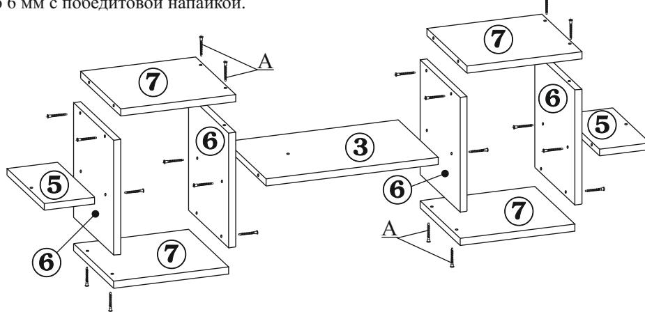
Все детали соединяются между собой с помощью Винтовой стяжки (поз.А).
