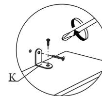
3.6. Разметьте и просверлите отверстие в стене, забейте дюбель. Закрепите стеллаж к стене шурупом 4x40 сквозь деталь №10 предварительно просверлив в ней отверстие 5мм или с помощью монтажного уголка.
