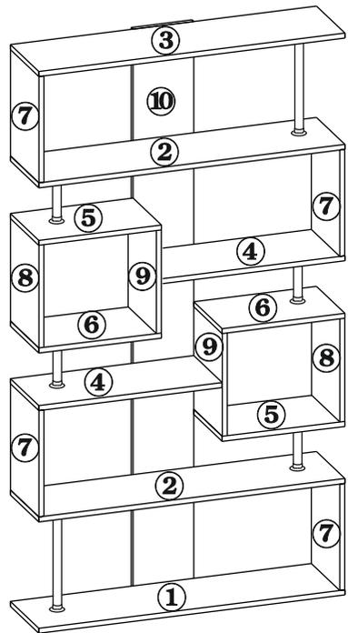
3.1. На детали №1, №2, №3, №4, №5 и №6 с помощью шурупов (поз. Е) установите штангодержатели (поз.В). Снизу на основании (дет.№1), с помощью шурупов (поз.3) установите опоры (поз.Б). Винтовой стяжкой (поз.А), закрепите деталь №7. В штангодержатель установите трубу (поз.Г), и зафиксируйте ее стопорным винтом расположенном в штангодержателе с помощью ключа (поз.Л).
