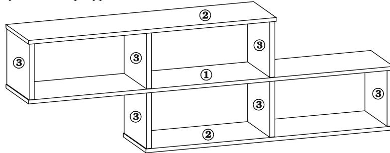
3.2. К детали №1 присоедините две детали №3 используя по одной Винтовой стяжке на деталь, используя отверстия в детали №1 расположенные ближе к тыльной стороне полки..
