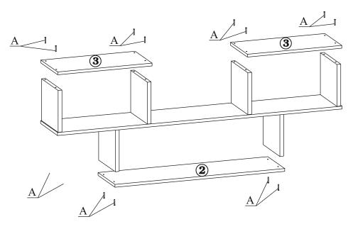
3.4. С обратной стороны закрепите навеску при помощи шурупов 3х20..
