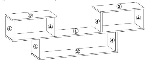
3.2. К детали №1 присоедените четыре детали №4 сверху при помощи Винтовой стяжки. Аналогичным способом закрепите две детали №4 расположив их снизу детали №1.
