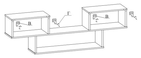
3.5. Разметьте место на стене для навески полки. Просверлите отверстия, забейте дюбеля, закрутите шурупы 4х40, повесте изделие.
