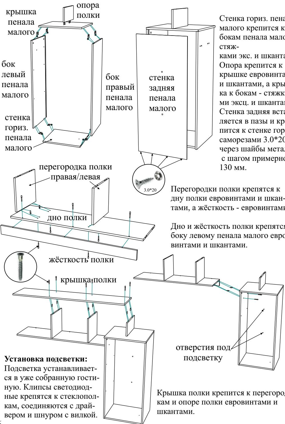
Стенка гориз. пенала малого крепится к бокам пенала малого стяжками экс. и шкантами. Опора крепится к крышке евровинтами и шкантами, а крышка к бокам - стяжками эксц. и шкантами. Стенка задняя вставляется в пазы и крепится к стенке гориз. саморезами 3.0\*20 через шайбы метал. с шагом примерно 130 мм.
