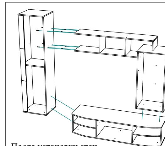
После установки стенки и регулировки высоты ножек, заглушками самоклеящимися закрываются отверстия для ножек.
