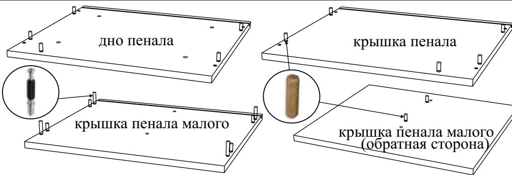
На крышки: пенала и полки, дно: пенала, тумбы и полки устанавливаются шканты, на фасады ящиков - штоки эксцентриков.
