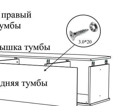
Стенки горизонтальные крепятся к бокам и перегородкам тумбы стяжками эксц. усилен. Стенка задняя крепится к перегородкам и стенкам гориз. саморезами 3.0\*20 через шайбы метал. с шагом прим-но 130мм. Ножки-стойки крепятся к дну пенала и тумбы.
