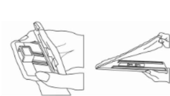
3. Вертикальный отжим с роликом и спойлером: установите рычаг регулятора отжима на необходимый уровень, сложите швабру и потяните вниз специальных механизм до конца насадки, затем поднимите его обратно вверх. Таким образом лишняя жидкость сольётся в ведро.
