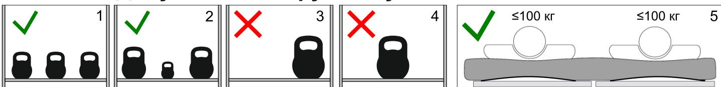
Распределяйте нагрузки равномерно по всем рабочим поверхностям (см. схему 1). Самые тяжелые объекты рекомендуем ставить по краям (см. схему 2). Сосредоточенная в одном месте нагрузка (см. схемы 3, 4) нарушает устойчивость изделия, а также сокращает срок службы отдельных элементов и механизмов.
