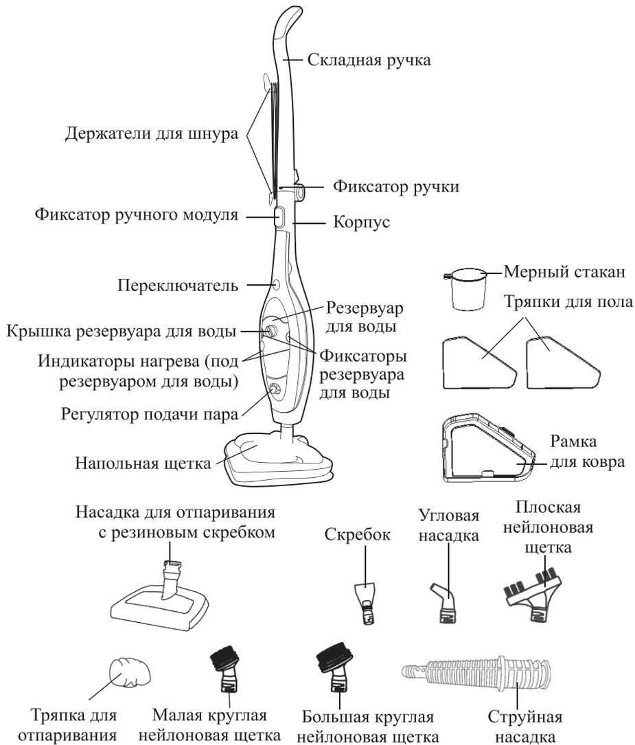
**Переключатель** включает и выключает устройство. Переведите переключатель в положение «I», чтобы включить нагрев бойлера и подачу пара, и в положение «O» — чтобы выключить. Когда устройство включено, горит индикатор переключателя.
