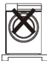
Установка на кронштейн
