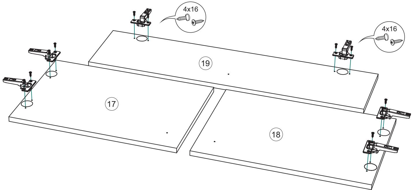
**15. Закрепите фасады и отрегулируйте зазоры.**
