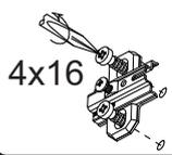
5. С помощью евровинтов соедините перегородки №3, №4 с вязкой №8. Затем используя эксцентриковые стяжки соедините перегородки №3, №4 с вязкой №9.
