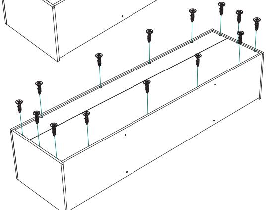
**12.** Опоры по краям установите так, чтобы их одновременно можно было соединить с боковинами №1, №2 и вязкой №8. К боковинам №1, №2 опору следует прикрутить шурупами 4x25, а к вязке №8 шурупами 4x16.
