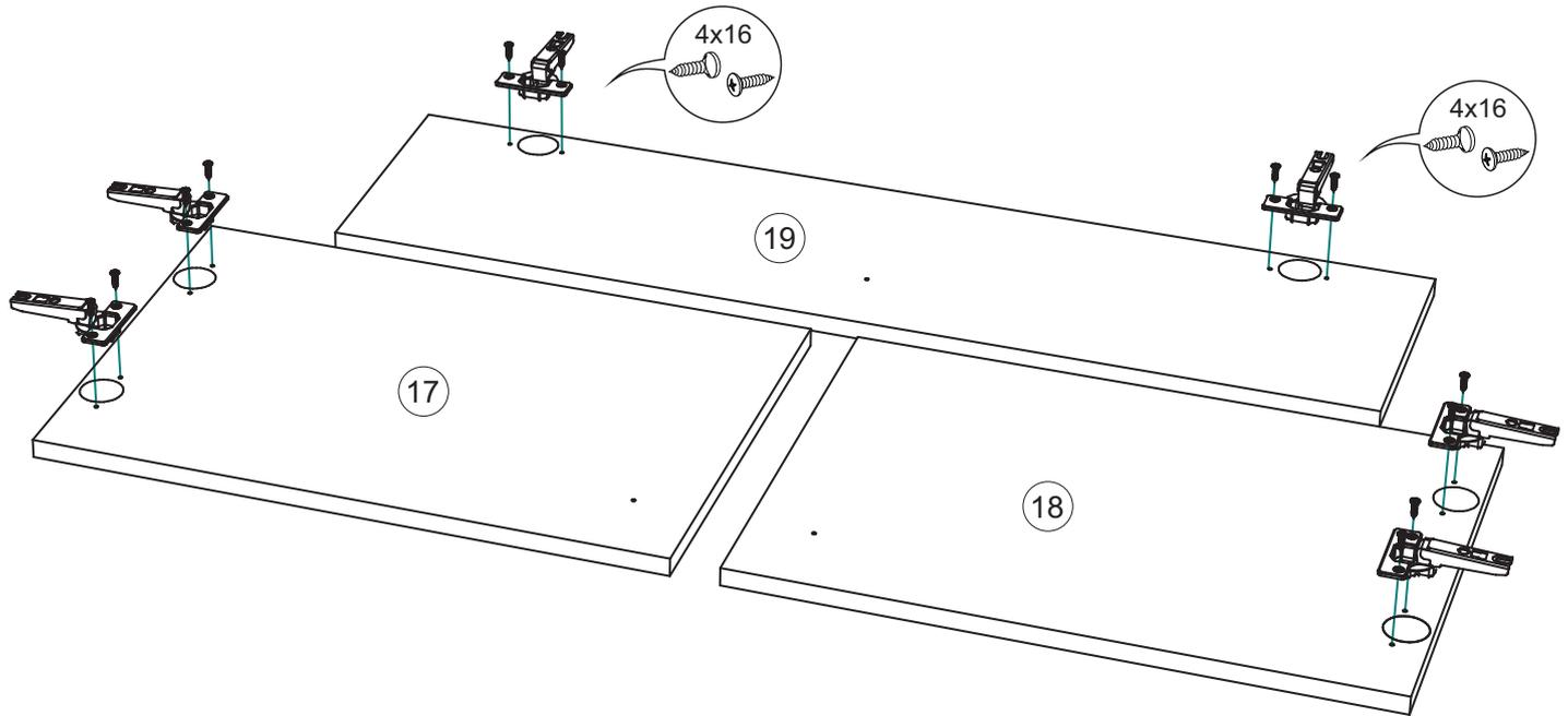
15. Закрепите фасады и отрегулируйте зазоры.
