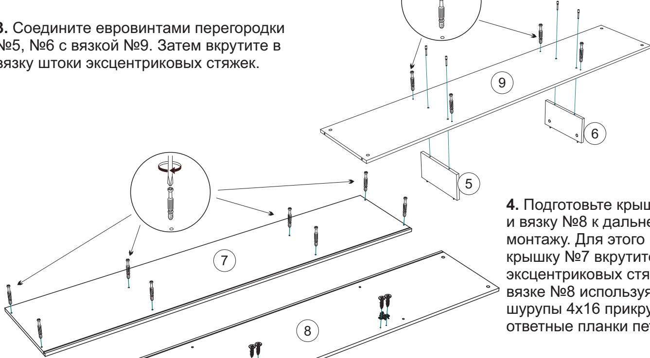
4. Подготовьте крышку №7 и вязку №8 к дальнейшему монтажу. Для этого в крышку №7 вкрутите штоки эксцентриковых стяжек. К вязке №8 используя шурупы 4x16 прикрутите ответные планки петель.
