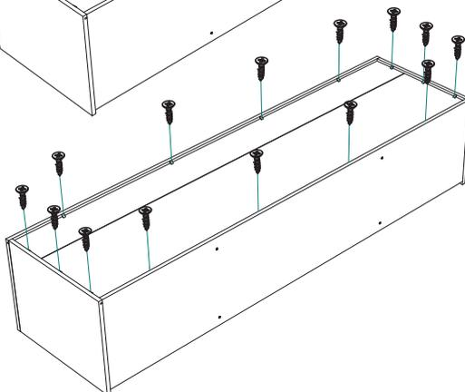
12. Опоры по краям установите так, чтобы их одновременно можно было соединить с боковинами №1, №2 и вязкой №8. К боковинам №1, №2 опору следует прикрутить шурупами 4x25, а к вязке №8 шурупами 4x16.
