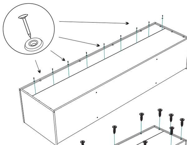
11. Используя уголки RV-8 и шурупы 4x16 закрепите задние стенки №14, №15 к боковинам №1, №2, крышке №7, вязке №8.
