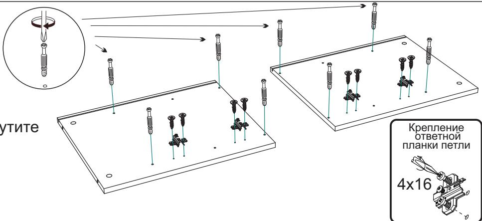
7. С помощью эксцентриковых стяжек соедините боковины №1, №2 с вязками №8, №9.
