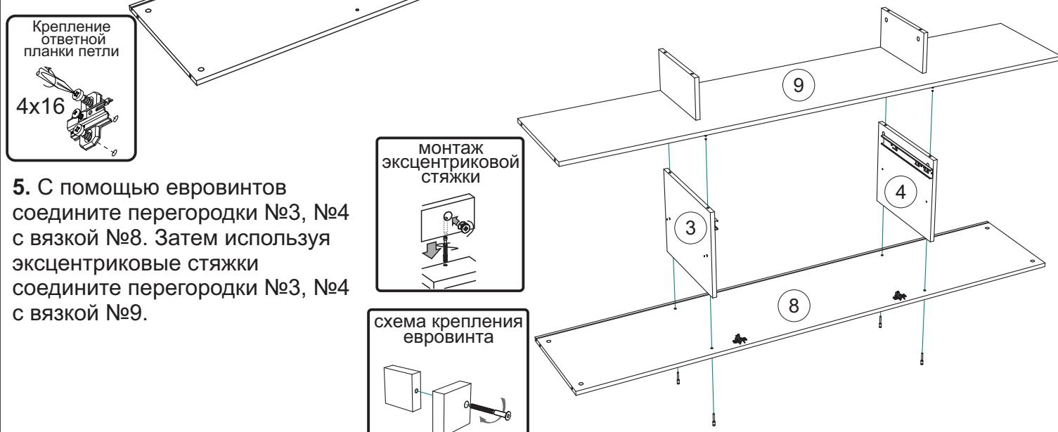
5. С помощью евровинтов соедините перегородки №3, №4 с вязкой №8. Затем используя эксцентриковые стяжки соедините перегородки №3, №4 с вязкой №9.
