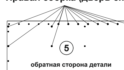
Схема 2. Досверливание отверстий (Ø8 мм) Правая сборка (дверь справа)
