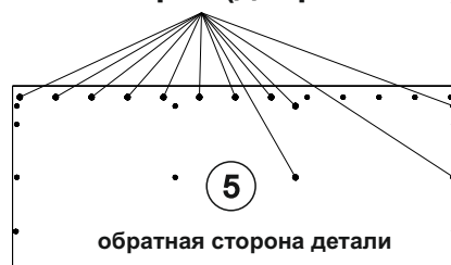
Схема 2. Досверливание отверстий (Ø8 мм) Левая сборка (дверь слева)
