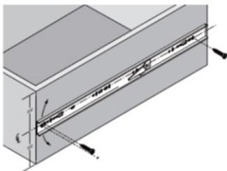
4. Установите направляющую (деталь №79) на детали №5 и №6 заглушаемой частью к фасаду, закрутите шурупы (деталь №54) в двух местах отверстий.
