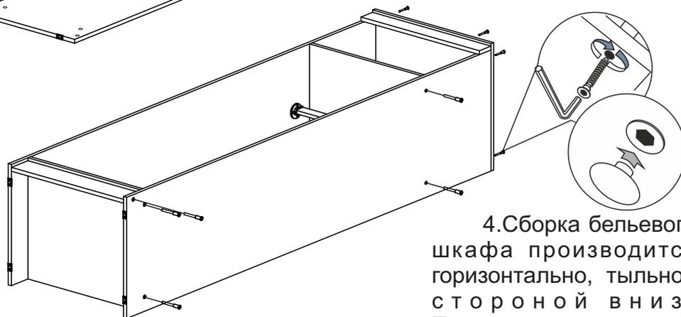
4. Сборка бельевого шкафа производится горизонтально, тыльной стороной вниз. Предварительно на боковины №17, №18 установите полкодержатели. Соедините боковины №17, №18 связками №19, крышкой №20 и цоколем №14 еврошурупами. Закрепите планку №16 к крыше №20 еврошурупами как показано на схеме 3.
