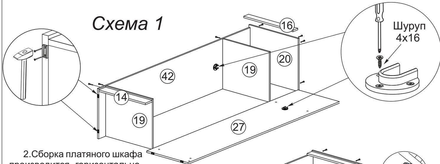
2. Сборка платяного шкафа производится горизонтально, тыльной стороной вниз. Предварительно на боковины №42 и №27 закрепите штангодержатели шурупами 4x16. Соедините боковины №27, №42 связками №19, крышкой №20 и цоколем №14 еврошурупами. Закрепите планку №16 к крыше №20 еврошурупами как показано на схеме 1.
