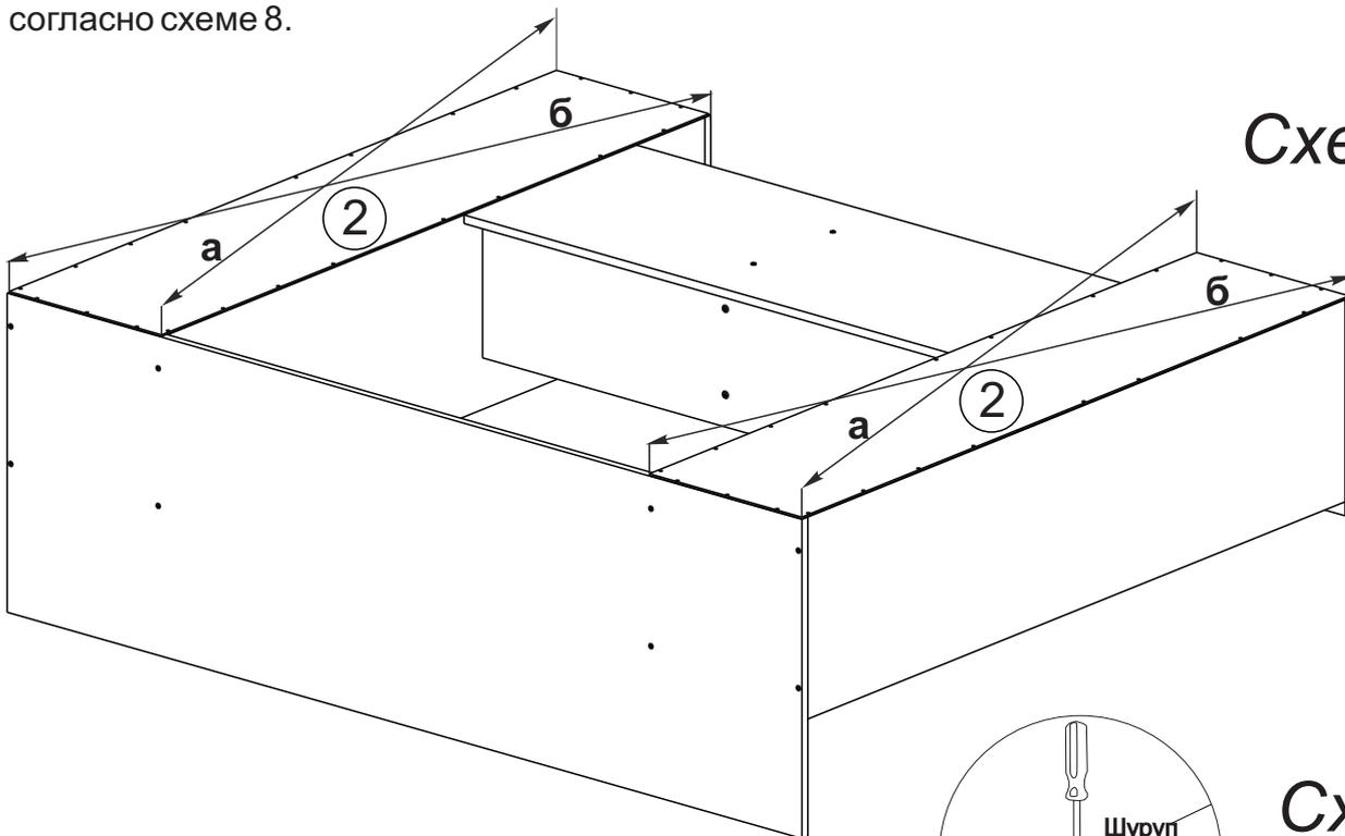
10.На перегородки № 25 и №32 установите направляющие для ящика с помощью шурупов 4x16 как на схеме 9
