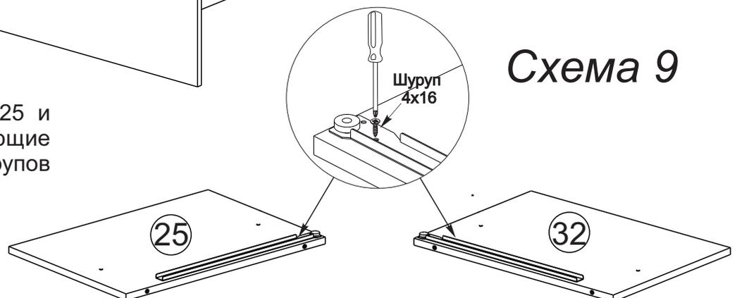
12. Соедините вязку №22 с перегородками евроинтами. Так же планки №24, №34 с перегородками №25 и №32. Соедините деталь №29 с перегородками №25, №32 еврошурупами как показано на схеме 10.
