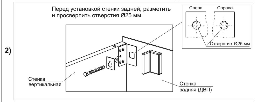
Перед установкой стенки задней, разметить и просверлить отверстия Ø25 мм.
