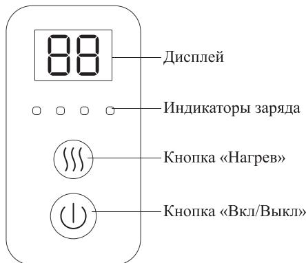
Чтобы включить или выключить прибор, необходимо нажать и удержать несколько секунд **кнопку «Вкл/Выкл»**. Циклическое нажатие на кнопку переключает 6 скоростей работы, на дисплее отображается номер скорости «01», «02», и т.д. до «06».
