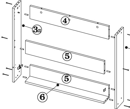
3.1. Шурупами 3x16 прикрутите фиксатор к дет. №3л и ответную часть к дет. №3пр. С нижней стороны полки дет. №6 шурупами 4x16 прикрутите выкатные колеса. С помощью шкантов и винтовой стяжки, соедините боковины стола дет. №3л и дет. №3пр с деталями №№4, 5, 6.
