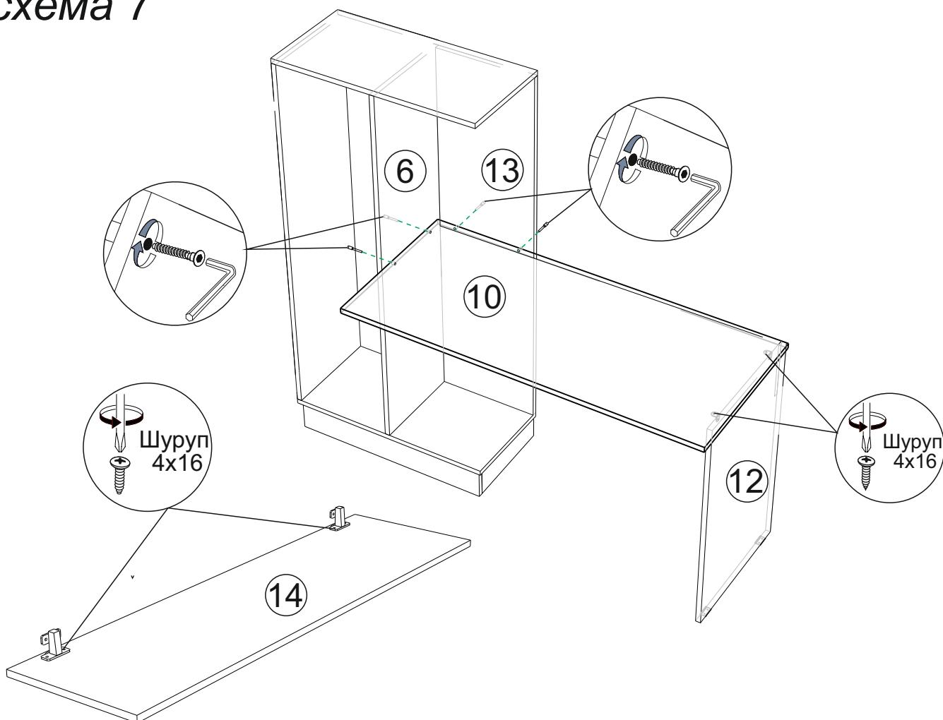
9. Закрепите створку №14 в ответные планки петель на боковине, зафиксируйте винты отрегулируйте и выставьте зазоры согласно схеме. Закрепите ручку с помощью шурупов 3,5x30. Установите полки №11 как показано на схеме 8.
