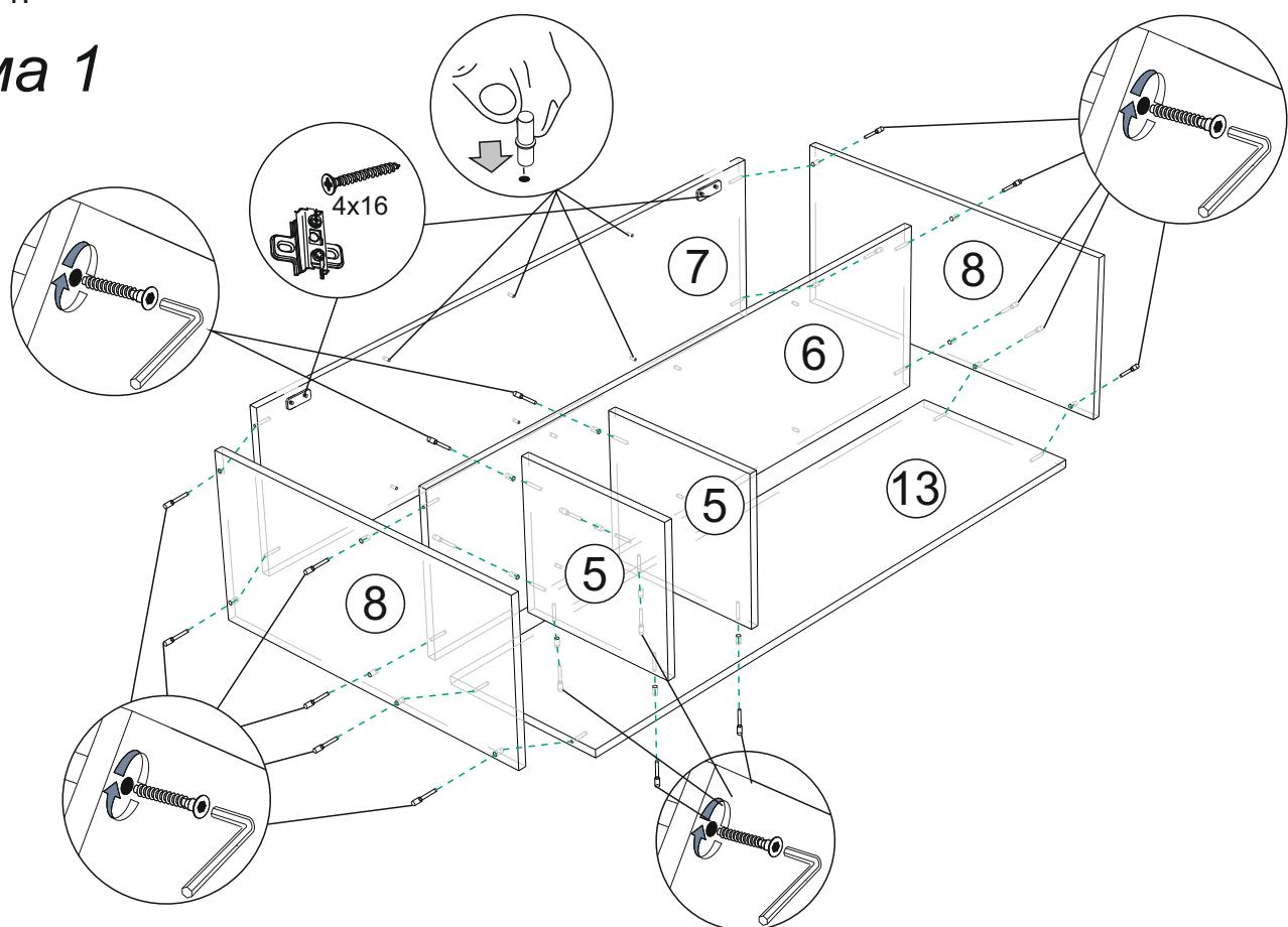
3. Чтобы установить заднюю стенку №1, необходимо собранную конструкцию перевернуть лицевой стороной вниз. Замерить, с помощью рулетки, и уравнять диагонали ( $a=b$ ). Наложите заднюю стенку и аккуратно, не нарушая диагоналей, прибейте ЛДВП гвоздями с шагом 130-150мм как показано на схеме 2.
