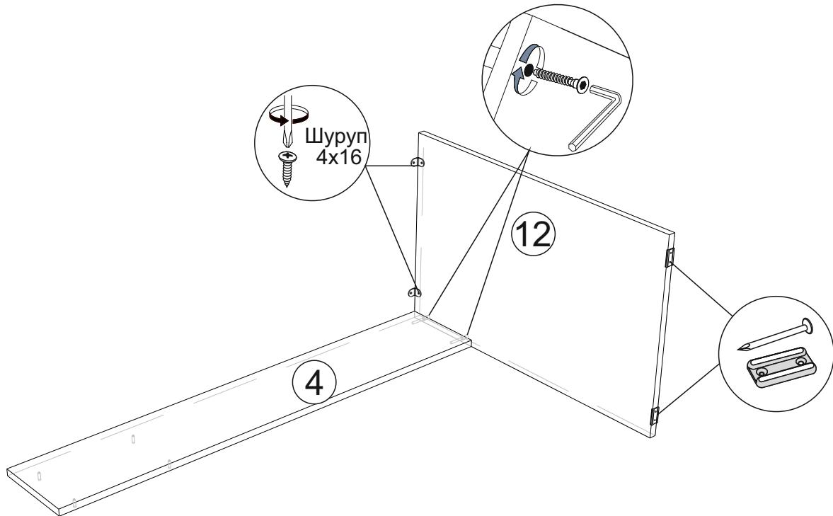
7. Установите шкаф в вертикальном положении на цоколь, присоедините к шкафу собранную конструкцию из царги и боковины, и закрепите сцаргу к задней стенке шкафа с помощью шурупов 4x30 как показано на схеме 6.
