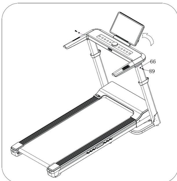
1. Закрепите компьютер на стойке болтом (89) и шайбой (66) с помощью ключа-шестигранника (10).
