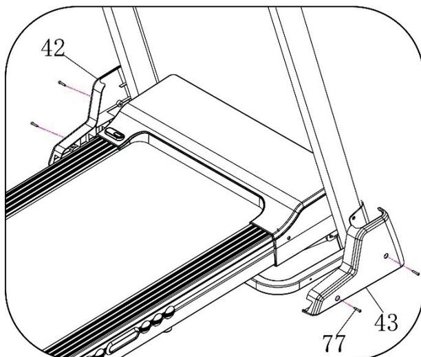
1. Используйте гаечный ключ с отвёрткой (12), болт (77) для фиксации левой крышки основания (42) в опорной раме.
