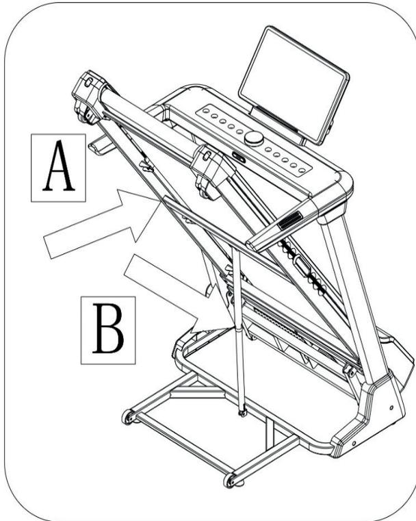
Потяните опорную раму дорожки вверх до положения А. Когда пневматический стержень будет заблокирован в цилиндре, раздастся характерный звук.
