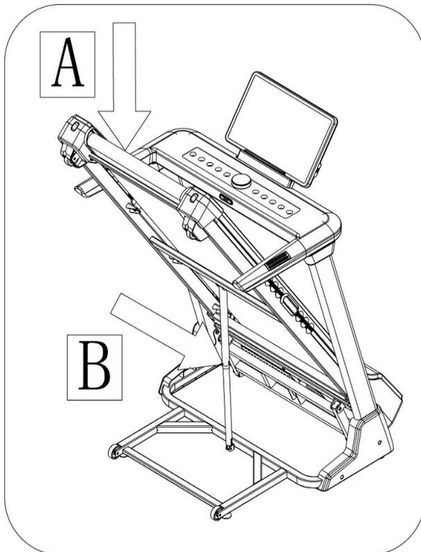
Придерживая рукой основную раму (там, где обозначено А на рисунке), резко надавите на пневматический стержень - основная рама дорожки разложится автоматически.
