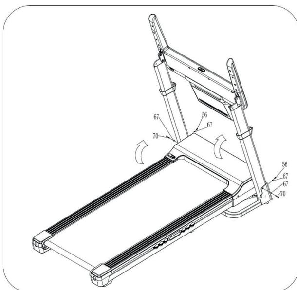
1. Удерживая стойку рукой, зафиксируйте её на основной раме справа болтом (70) и шайбой (67) с помощью ключа-шестигранника (10).
