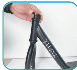
Установите прокладку на штырь сиденья, как показано на рисунке
